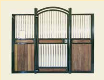
Frontal Chantilly Mixto 300 cms. Acabado con perfiles cincados y lacados. Barrotes en acero inoxidable o acero galvanizado en caliente. Madera tropical.
